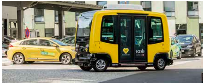
Emily, der autonome Kleinbus der Deutschen Bahn, fährt schon erste Runden auf dem Euref-Campus Testgelände in Berlin.
